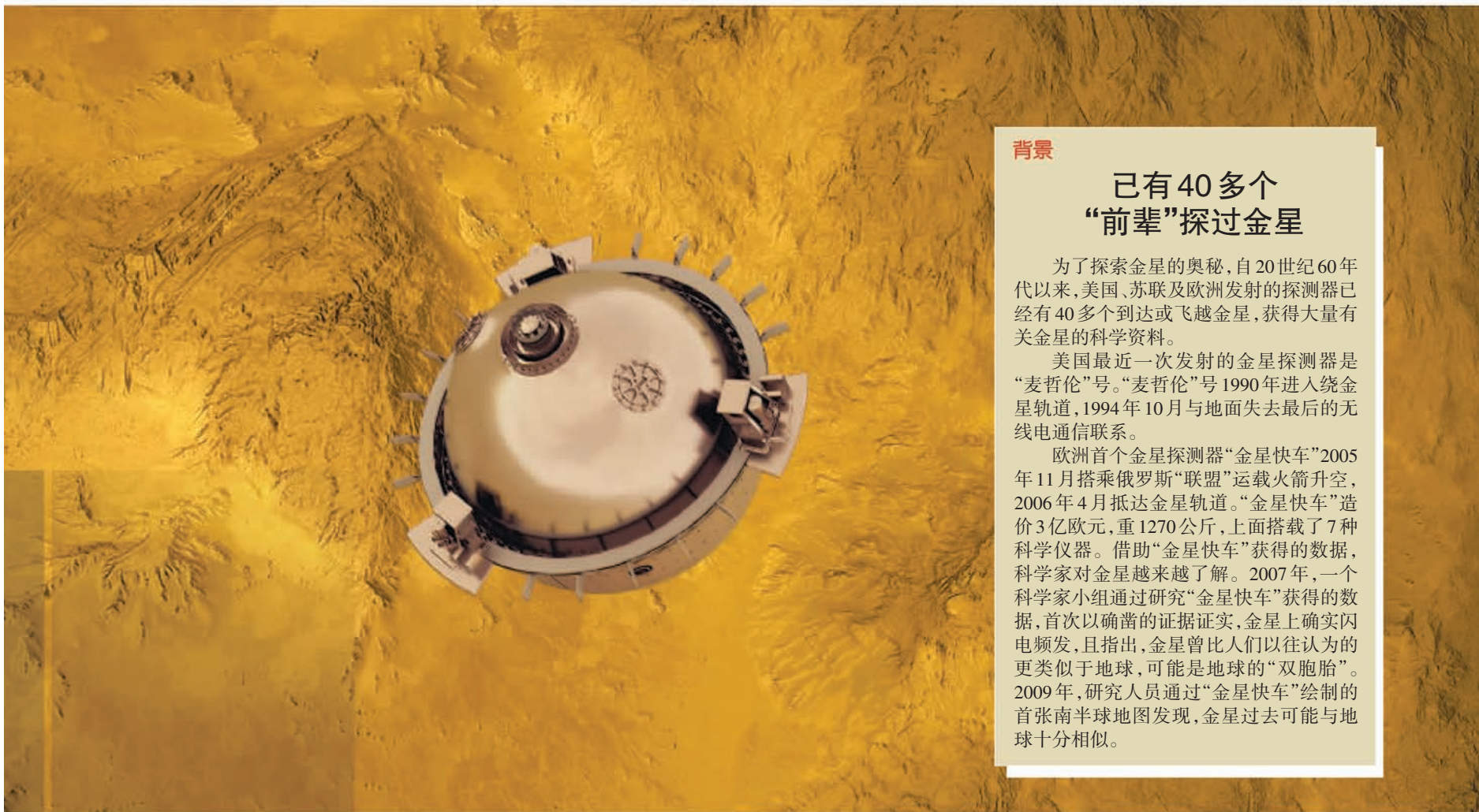
▲◀“达芬奇+”将发射一个直径约1米的小型球形探测器,探测器将穿过充斥着硫酸雾的金星大气层,缓缓降落金星表面。(想象图)
