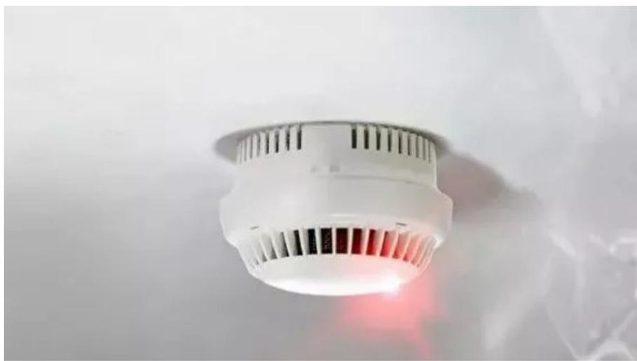
不同类型的火灾。光电报警器检测阴燃(闷烧的)火灾,电离报警器响应实际火焰。
