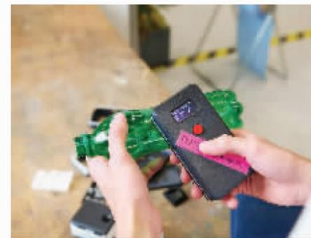
奖。Jerry借鉴了欧洲大型分拣设施中已有的红外光谱技术,但换成了更实惠的“离散红外光谱”版本设计了这款手持式的塑料扫描仪,它能够运用不连续的红外光线探测出不同类型的塑料,让用户了解塑料的成分,改善塑料回收利用的流程。此外,它还是全开源硬件,任何人都可以组装。
