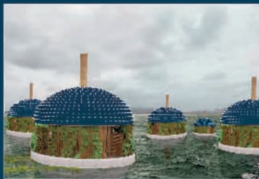
在暴风雨来临前,每栋房屋会通过冲击传感器吸入大量水,“膨胀起来”,底部沉入水下,房屋变重,从而避免被冲走。
