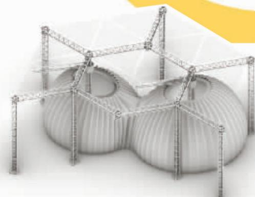
TECLA屋使用多级模块化3D打印机构建,建造过程仅用了200小时。
