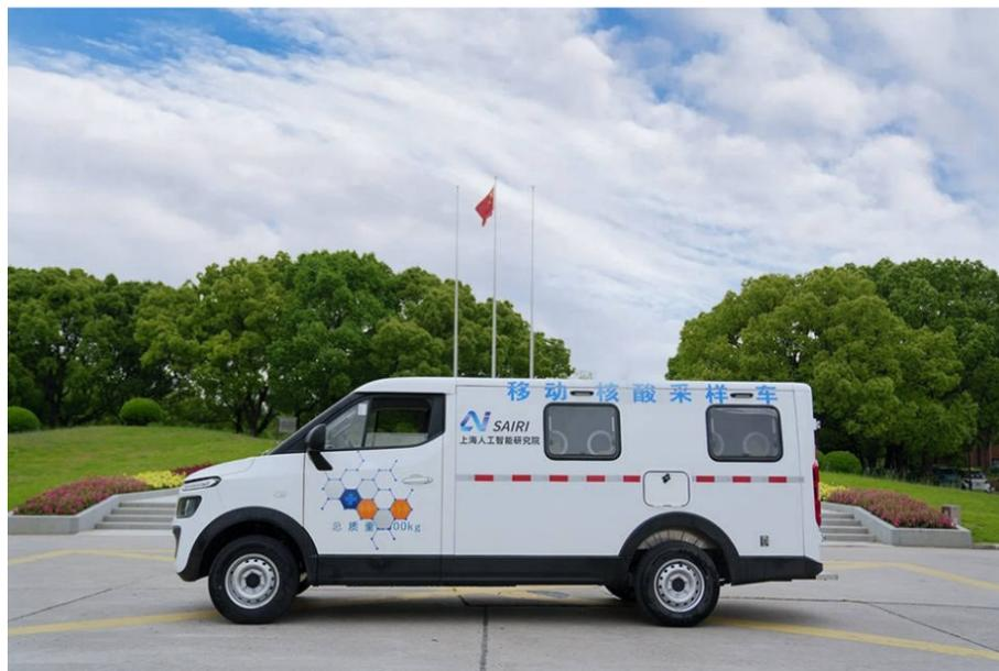
走到车前扫码,左转,来到采样窗口,张嘴,镜头识别口腔位置,机械臂带动采样棉签塞入口中,转动采样。其后机械臂对准试管塞入,另一支机械臂伸过来剪断采样棉签,棉签入试管。试管伸到车顶部,上下两个端口交接,拧上试管,再放到底部试管架,一次无人操作核酸采样完成,仅需用时30秒。
